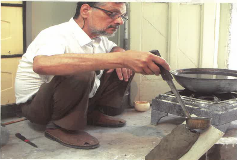
Fig. 26 - Pour wax into the reed mold
